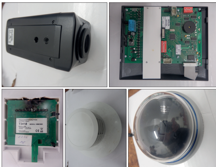
Obr. 1. Zcela poškozené kamerové a zabezpečovací systémy kulturní památky (Zdroj: Rozbor mimořádných událostí způsobených úderů blesků v roce 2012, sborník č. 4/2012 UNIE SZ)
